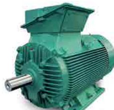
FLSES IE2 - IE3 - IE4 Żeliwo* IP55 Wysokość osi 80 do 450 mm 2, 4 oraz 6 biegunów 0,75 do 900 kW
